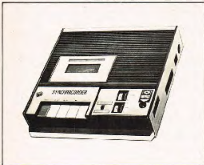
Med denne enkle båndoptager kan der indføres styreimpulser i det øverste spor, der ved afspilning aktiverer et relæ.
