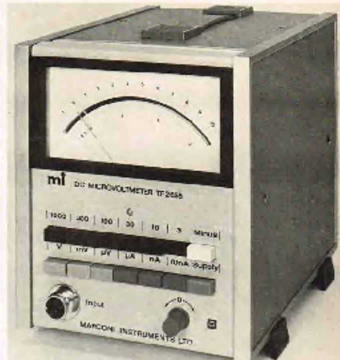
Onsktaren mellem de forskellige måleområder sker ved hjælp af trykknapper, og betjeningen er derfor meget enkel.
