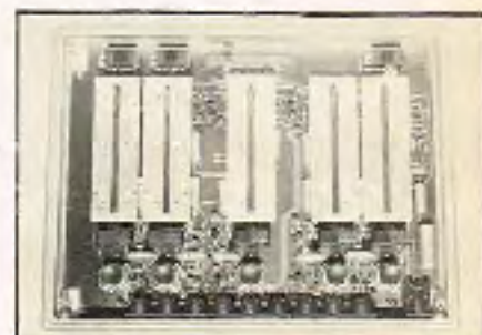
Frontdækslet er fjernet. Det hele er monteret på et samlet print.
