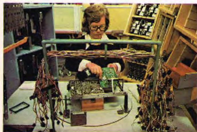
Alle modulerne samles på et chassis og ledningsbundter sørger for elektrisk forbindelse mellem de enkelte moduler.
