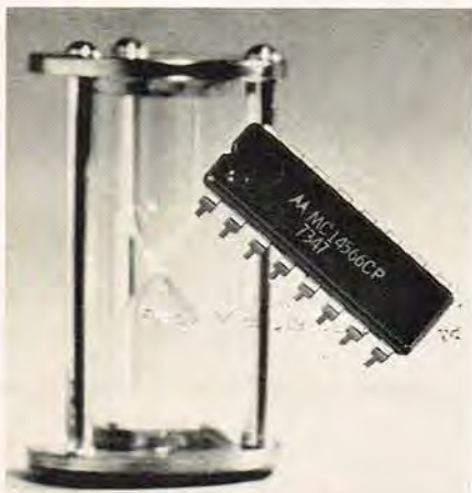
Ydelserne fra IC'erne bliver mere og mere avancerede. Her MOTOROLA's MC14566 indkapslet i en standard 16-terminals pakning.
