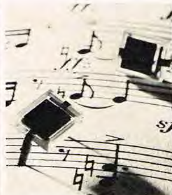
Her er en lille fotodiode, BPW 34, beregnet for infrarødt lys. Systemfladens dimension er kun 9 kvadratmillimeter.
