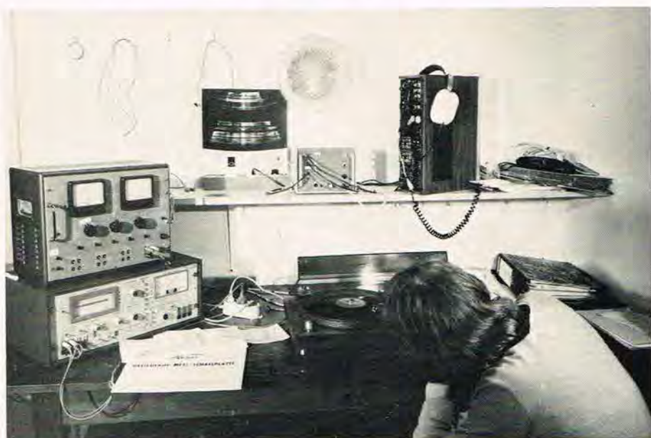
En prøvestand i Hi Fi Stereophoni's testlabor – her måles wow på en pladespiller. Laboratoriet ledes af den internationalt kendte forsker Karl Breh og artiklerne bringes i PE med skandinavisk eneret.
