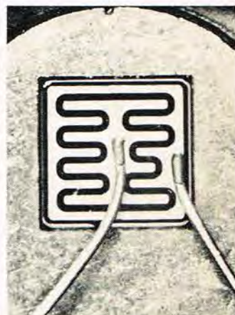
Øverst ses et billede af chip'en fra en 2N3055 af fabrikatet Fairchild, hvor arealet er 11 kvadratmillimeter. De to tråde er tilledninger, og kaldes for »bonding«. På denne chip er ikke bemærket fejl.
