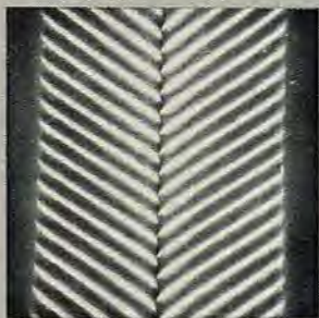
Elektronmikroskop-foto af pladerille med 30 kHz CD-4 pilottone efter 100 afspilninger med 2 grams nåltryk og Shibata-nål.
