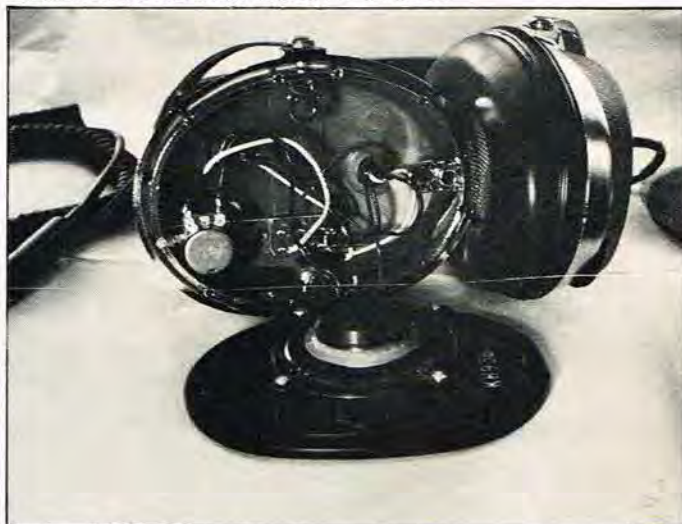
Venstre enhed på PHASE/2 indeholder en omskifter-knap med automatisk tilbagespring. Den bruges til A/B-test mellem signalet med og uden panorama-funktionen indkoblet.
