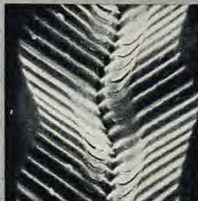
Samme rille efter 25 afspilninger med nåltrykket 4,5 gram og kønisk nål.
