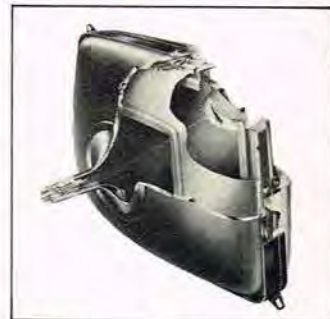
Billedet viser et farvejernsynsrør skåret op, så man kan se de tre elektronkanoner. På billedet ses også de usynlige elektronstråler samlet i et punkt (PHILIPS).
