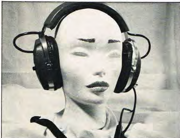
Højre enhed på PHASE/2 har ligesom venstre en fingerskive i underkanten til regulering af panorama-virkningen. Desuden sidder fase-vender funktionen »Ambience-Expander« på bagsiden af denne enhed.
