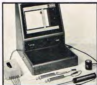
Det komplette måleudstyr med lastcelle og længdegivere.
