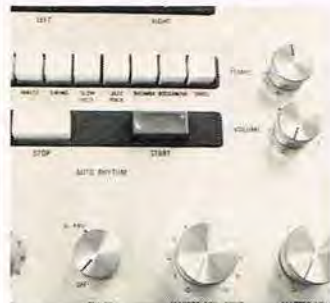
Højre halvdel af frontpladen indeholder foruden VU-metrene også de specielle »musiker-funktioner«: Rytmebox og stemmetonegenerator. Styrkekontrollen længst nede til højre er Master (hoved-) kontrollen.
