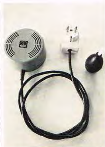
Den akustiske afbryder. Ved siden af enheden ses gummibolden forsynet med 14 kHz fløjten, som også ligger som en separat fløjte.
