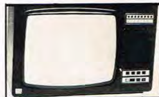
ITT's »Studio 1440 color« er med et 20" farve-billedrør. Foroven de 8 »easy-touch« knapper for kanalvalg.
