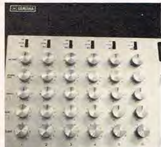
Venstre halvdel af Yamaha mixerens frontplade indeholder de mange betjeningsgreb til de 6 indgange.
