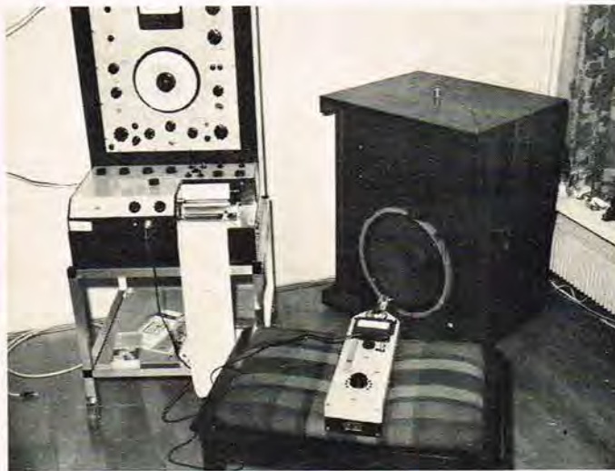
Foto 1: Måleopstillingen ved optagelsen af vibrationskurver for en JBL Studio Monitor. På toppen af kabinettet ses B&K accelerometret 4338, som via lydtrykmåleren 2209 er forbundet til niveauskriverværktøjet. Tonegeneratoren, som styres af skriveren, leverer sit signal til højttaleren via for- og kraftforstærker.
