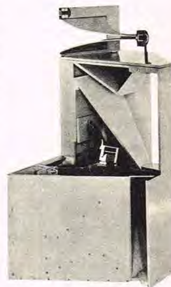
Denne gennemskårne model viser Klipschhornet, som det ser ud i dag. Inde i bashornet ses bashøjttaleren placeret i sit lukkede »bagrum« samt en del af den eksponentielt voksende lydpassage til hornets bagside. På toppen ses det gennemskårne mellemtone-horn med diskanthornet siddende i overkanten.
