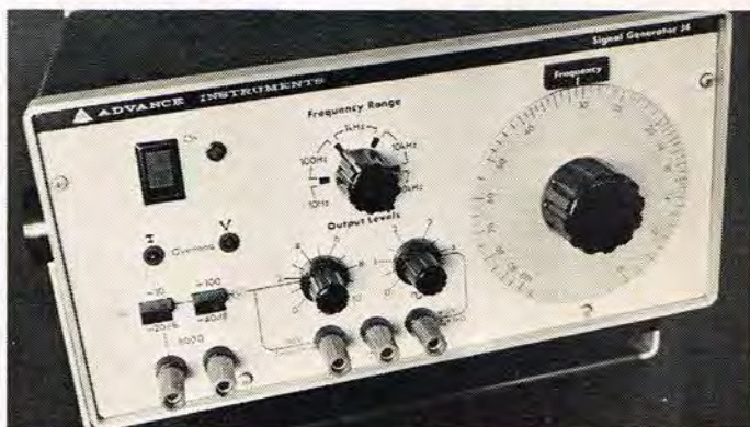
ADVANCE Instruments tonegenerator fra 10 Hz til 100 kHz. Den er i stand til at afgive en effekt på 7 W/15 ohm med et signalniveau på 10 V.
