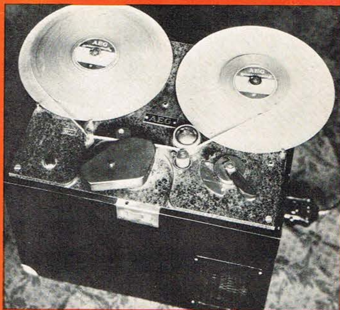
En af verdens første båndoptagere, AEG-TELEFUNKEN's model »K3« i transportabel udførelse fra omkring 1935/36. Til modellen hørte en kulkornmikrofon af »Querstrom«-typen samt yderligere to separate kufferter for forstærker og højttaler. Har De denne er De en sikker »vinder«.
