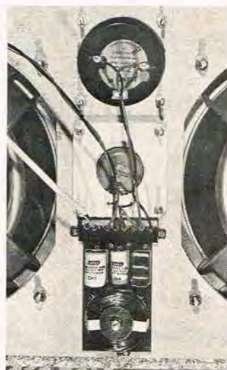
Passive delefiltre kan være mere eller mindre komplicerede og består altid af spoler og kondensatorer.
