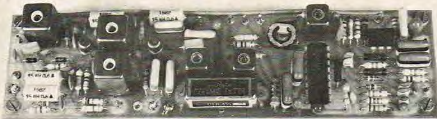
Et af printene i det nye danske radioanlæg. Forrest ses et keramisk filter og en IC til højre.
