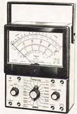
Det ny multimeter fra Simpson, der især er kendetegnet ved den store skalalængde. Foroven på betjeningspanelet er »Reste«-knappen for sikringskredslobet.
