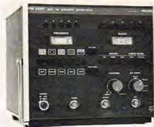
PHILIPS nye farvegenerator PM 5509, der udover gængse signaler for servicearbejde på TV-modtagere også kan levere et testsignal til brug for justeringen af video-båndoptagere efter VCR-systemet.
