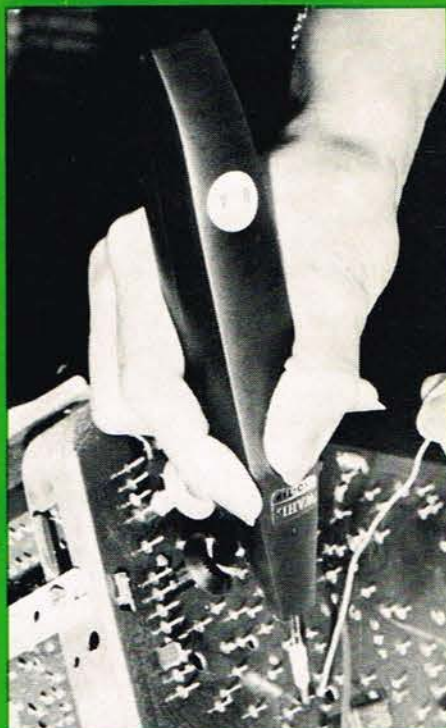
Denne loddekolbe strømforsynes fra et lille indbygget batteri, der kan oplades. Man undgår derved en generende netledning.
