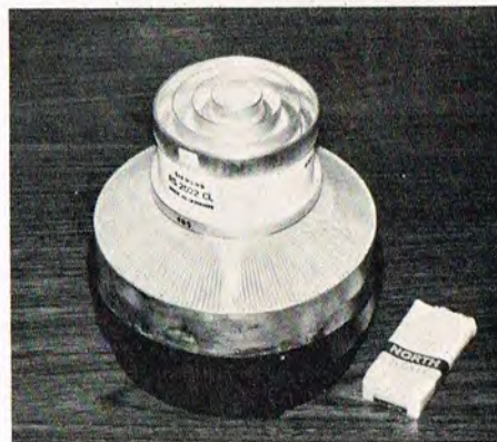
Tv-billedsenderens udgangseffekt-forstærker. Nærbilledet af »dyppekogeren« viser selve effektretet, der afgiver 95 kW udstrålet effekt.
