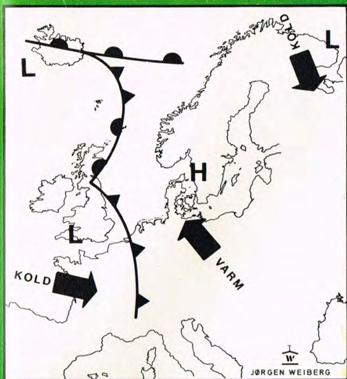
Et typisk vejrkort når forholdene er for god DX-modtagning på UHF. Øverst på foregående side: VHF-DX ved refleksioner i ionosfæren og UHF-DX ved refleksioner igennem fugtige lag. Der kan være flere inden sign. når antennen.
