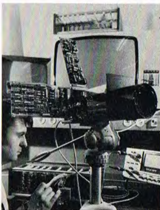
Siemens nye miniature farve-TV kamera med ét rør, benævnt Interplex. Metoden indebærer, at kameraets mekaniske mål ikke er større, end et normalt sort/hvidt kamera.
