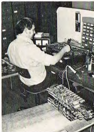
Kristians opgave er at fortrimme og afprøve samtlige printfunktioner for derefter at eliminere fejl. Så går det lettere med resten af fabriktionsproceduren.
