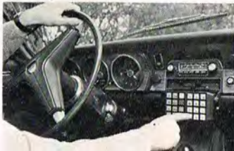
Storno's nye trykknappbetjente kontrolboks gør bilradioen lige så enkel at bruge som en almindelig telefon. Det er dette system »North Thames Gas« skal have installeret.
