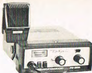
BN 5024 500 mW AM mobilstation 23 kanaler incl. nødkanal 11 a. Mål: 60 x 165 x 124 kr. 1.990,-.
