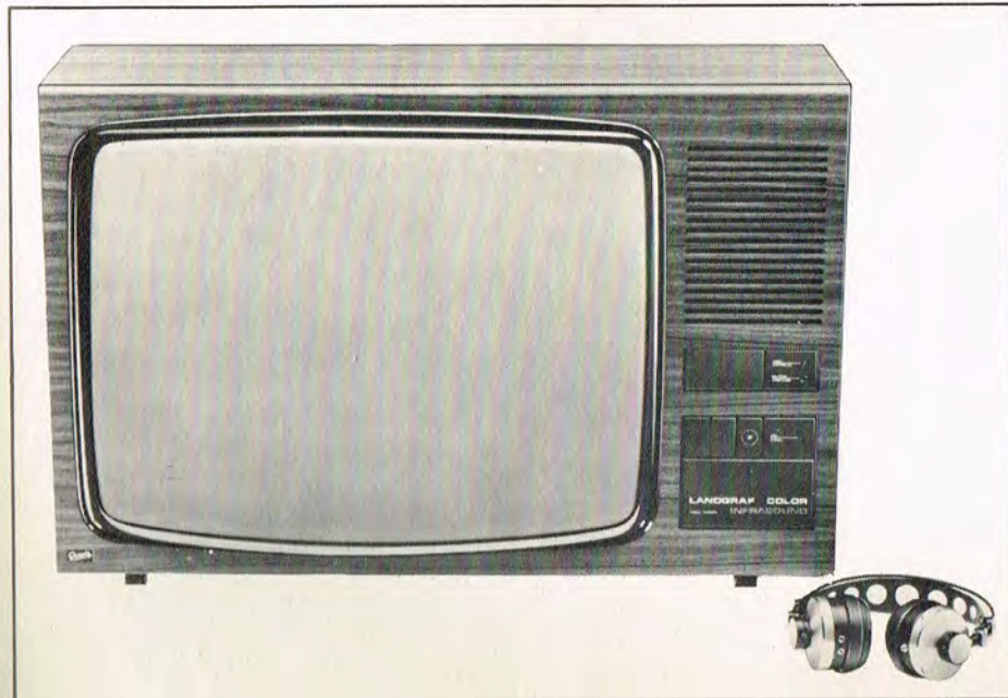
En farvetv-modtager med »Infrasound«. Senderen befinder sig lige under højtaltalgitteret. (Foto: Graetz)
