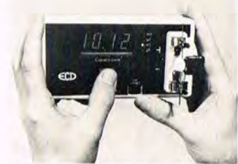
Den lille nemme kapacitetsmåler — en kondensator klemmes ned mellem to fjederkontakter, et tryk på en knap og man har værdien ved hjælp af flydende krystaller.
