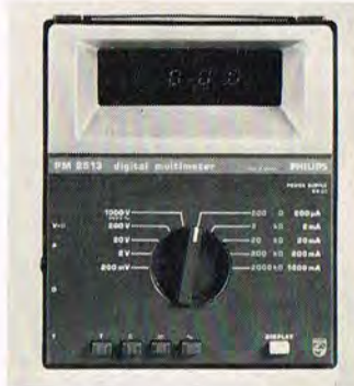
Philips nye batteridrevne digitalmultimeter. Betjeningen er enkel med en drejemojskifter for de forskellige områder.
