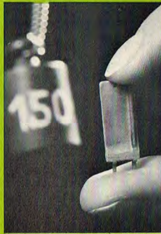
Her er det lille piezoelektriske element, der kan benyttes som »Sensor«-kontakt. Et lille tryk, og den udvikler en spænding på 0,8 V — se efter, om der ikke til næste sommer er en sådan på Deres transistormodtager eller det transportable TV-apparat.
