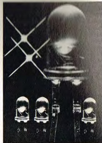
Her den nye grøntlys-diode LD57C fra SIEMENS med en lysstyrke på 30 mcd ved en strøm på 10 mA. Den er her indstøbt i et kunststofhus for opnåelse af mere diffust lys. Soklen er 8,6 mm med en diameter på 5,1 mm.
