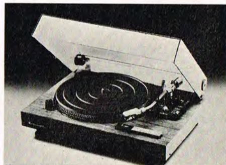
KENWOOD pladespilleren KD-5033 — en HI-FI pladespiller i den mere avancerede klasse udstyret med en 8-polet DC-motor, som benyttes ved »Direct Drive«-systemet. Med den påmonterede pick-up af »MM«-typen (Moving Magnet) opnås et signal/støj-forhold på mere end 58 dB, fortæller specifikationerne.
