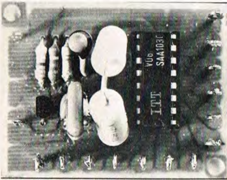
Foto af monteret orgelgenerator.
