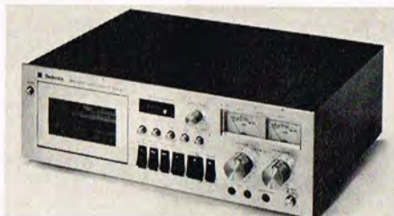
TECHNICS kassettebåndoptageren type RS-671USD hvor båndkassetten ilægges fra fronten (»front loaded«). Den er udstyret med 2 motorer, som betinger den lave wowprocent på 0,15.
