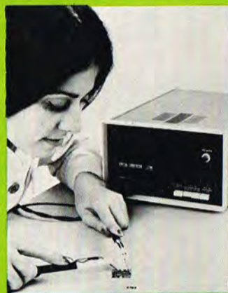
De nye 4-terminal prober, der vil betyde en stor hjælp ved målinger på miniaturrekredsløb.
