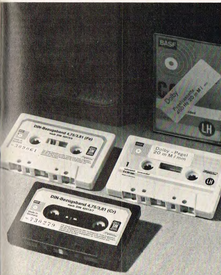
Skal man indjustere en kassette-båndoptager helt fra bunden, er det nødvendigt med forskellige test-bånd. Her er de såkaldte »Bezugsband« for jern- og krombånd samt en kassette for indjustering af Dolby kredsløb. (Foto: BASF).
