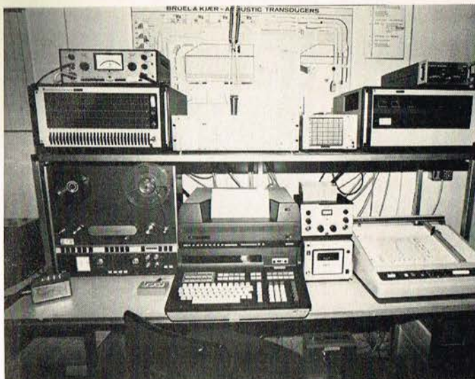
Her er hele opstillingen med det forskellige mæleapparatur. Til højre for datamaten en lille »kassette-båndoptager«, som kan arkivere op til 400 målinger på én kassette! Til højre skriveren, hvor man kan skimte en kurve.
