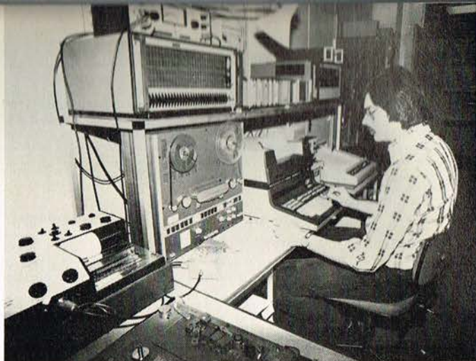
Laboratortekniker Eddy Brixen er her ved at måle på en stor REVOX båndoptager. Foran er datamaten, hvor man skimter papirstrimlen stikkende op. Over båndoptageren det store filter med de mange omskiftere til selektivt valg. Helt til højre skriveren.
