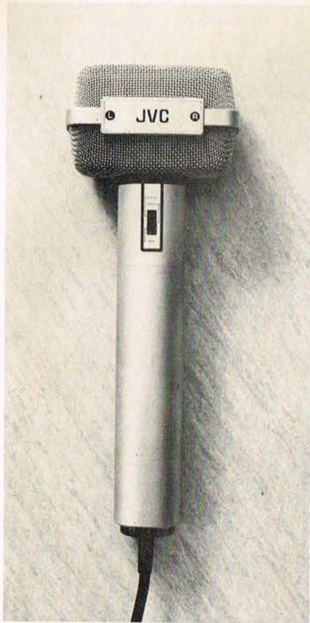
To mikrofonenheder i stereoudførelse findes også. Her er det en type »JVC«, model M201, som er udstyret med en indbygget forstærker i håndgrebet, der også indeholder et 1,5 V batteri. Foroven en lille omskifter, der kan dæmpe signalet 10 dB. (Foto: Fota-Fonex A/S).
