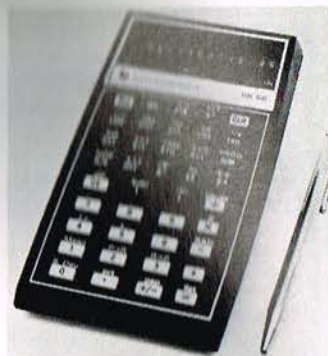
TEXAS INSTRUMENTS' lommeregner, model SR-56, hører til den avancerede type. Den er bl.a. udstyret med et uafhængigt testregister, hvorved det er muligt at foretage sammenligninger med tallet i lyspanelet — uden at gribe ind i selve beregningsgangen, og ydermere kan der indføres pauser i programmet.
