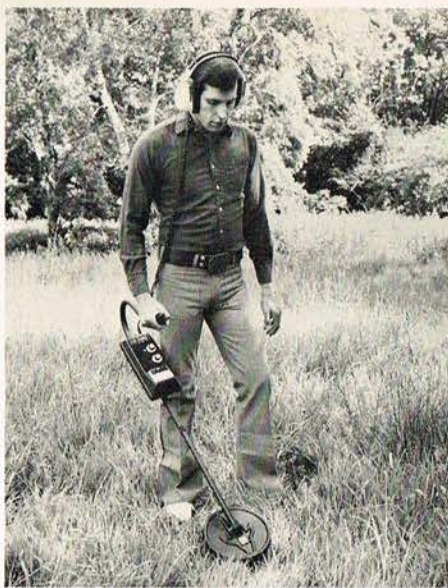
Denne model metaldetektor er med indikatorinstrument. Forinden er en spole i den cirkulære plade, der med sin stang kan skydes ud og ind ad det øverste rør.
