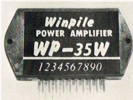
Med denne IC — der har minimale dimensioner — er det muligt at opnå op til 50 W udgangseffekt i en 8 ohms belastning — det er da vist næppe set tidligere!
