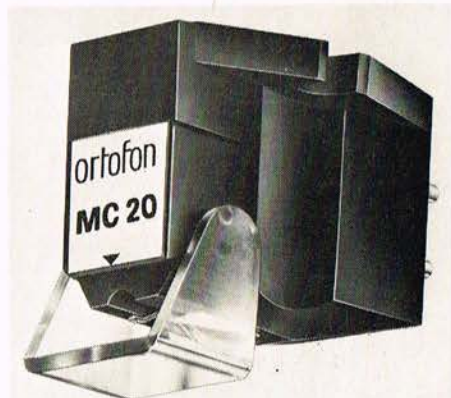
Den nye pick-up type MC 20 vejer ikke mere end 7 gram, og der anbefales et nåletryk på 1,7 g for opnåelse af optimal sporing.
