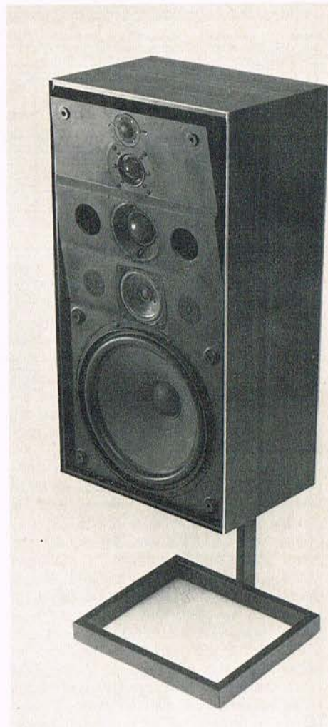
M 100 med frontstoffet fjernet, så de fem enheder kan ses. Bemærk den specielle front, som skal sikre samtidig ankomst af signalet fra enhederne. I dag er også bashøjttaleren overfladebehandlet.
