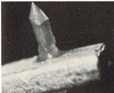
12b. Nål fra Goldring G 900 SE, afrundingsradier 5/18 \mu , elliptisk slibning, påfaldende lang, noget monteret, hel sten.
