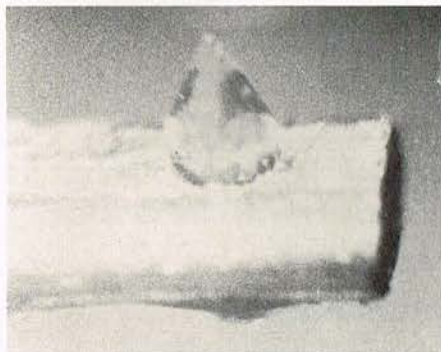
13b. Nål fra Ortofon MC 20, afrundingsradius 8 \mu , »fine linie« slibning, krystalorienteret nogen stav.
