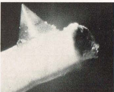
8b. Nål fra AKG P7E, afrundingsradier 8/18 \mu , elliptisk slibning, indfattet hel sten.
