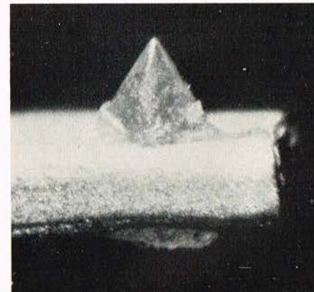
25b. Nål fra Ultimo DV-38/20 A. Shibata-slibning til CD-4. Krystalorienteret nogen sten.
