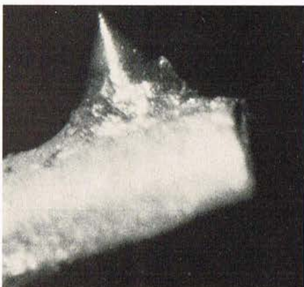
7b. Nål fra AKG P6E, afrundingsradier 10/20 \mu , elliptisk slibning, hel, metalindfattet sten.
