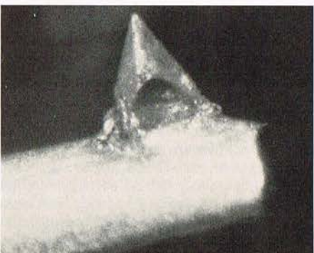
9b. Nål fra AKG P8E, afrundingsradier 5/18 \mu , elliptisk slibning, lille krystalorienteret stav.
