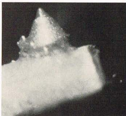
6b. Nål fra AGK P6R, 18 \mu afrundingsradius, sfærisk slibning, hel, metalindfattet sten.
