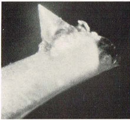
10b. Nål fra AKG P8ES, afrundingsradier 5/18 \mu , elliptisk slibning, nogen krystalorienteret stav.
