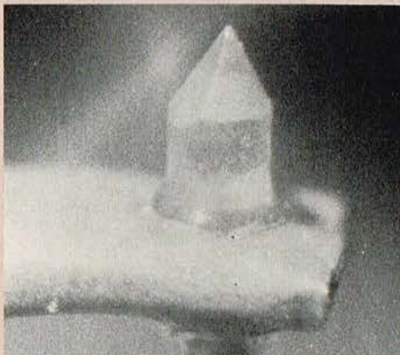
20b. Nål fra Shure M24H, slebet som hyperbel til CD-4. Relativ lang, noget monteret, hel sten.
