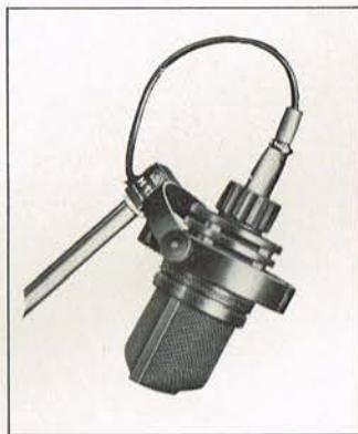
C414EB ses her med vindhætte og op-hæng type H 17, der er en integreret enhed. Selve mikrofonen er udstyret med to membraner, og der er derfor mulighed for skift mellem fire forskellige retningskarakteristikker.
