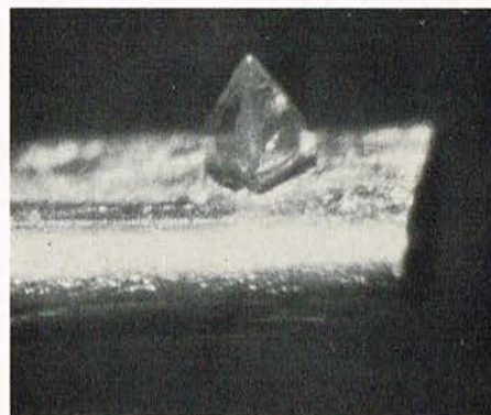
15b. Nål fra Ortofon SL 20 O, afrundingsradius 7 \mu , bi-elliptisk slibning, krystalorienteret nogen stav.
