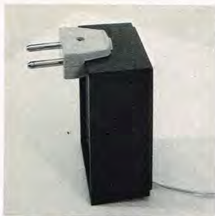
Bemærk den geniale løsning med 220 V hanstik direkte i indbygningskassen. Den er næppe lovlig, og efterligninger sker naturligvis helt på eget ansvar.
