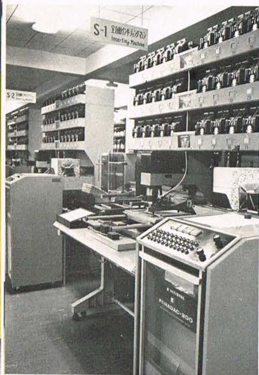
Automatisk produktion hos Technics. Et print starter i baggrunden, hvor 3 automatiske komponent-isættere placerer op til 150 komponenter. Maskinerne i forgrunden måler på det færdige print, og op til 100 funktioner kontrolleres af en micro-processor. Hvert halve minut passerer et nyt, perfekt print.
