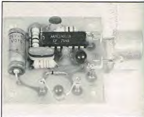
Det monterede print med transducer.
