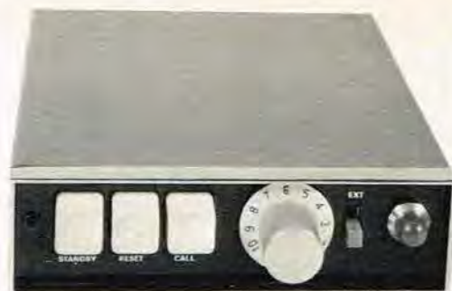
MOBIL 10 lige forfra. Bemærk 10 trins omskifteren og kontrollampen.
