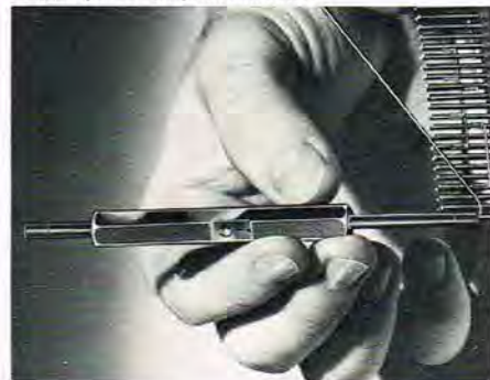
Wrapningen af en printconnector.
