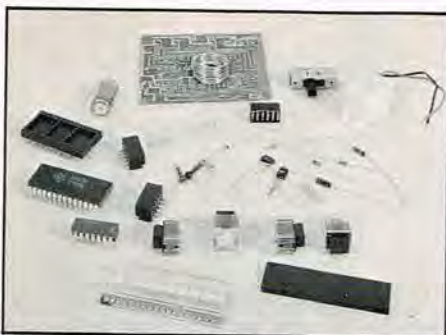
Komponenterne til digitaluret i fri dressur, bemærk de små elegante trykknapper, som er udformet til printmontage.
