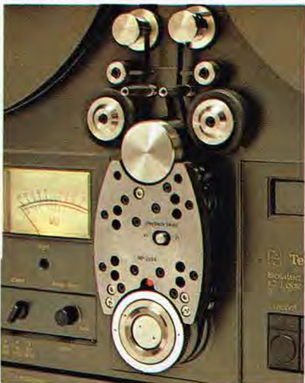
Nærbillede af Technics »Isolated Loop System«. Bemærk den store capstan og de to trykruller. Systemet reducerer båndtrækket i sløjfen til ca. 70 g.
