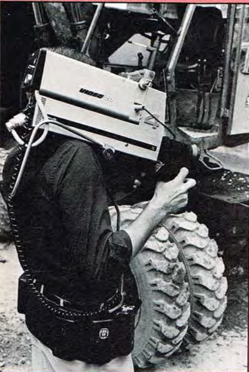
Video 80 kameraet i marke. Kameraet bæres via en solid skulderbøjle, og hele kameraet vejer kun 9 kg. Optikken er en 1:6 eller 1:10 zoom, og akkumulatører kan som her bæres i bæltet.
