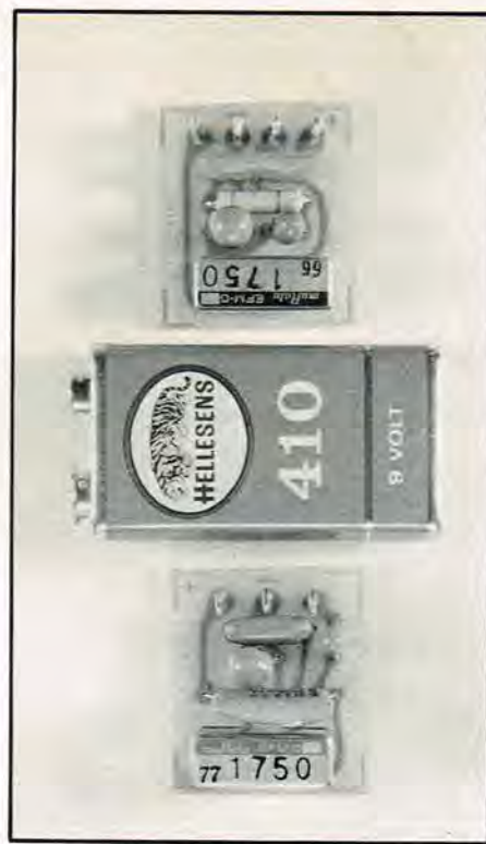
Sender- og modtager-print monterede, bemærk størrelsesforholdet til et 9 volt Hellelsen batteri type 410.
