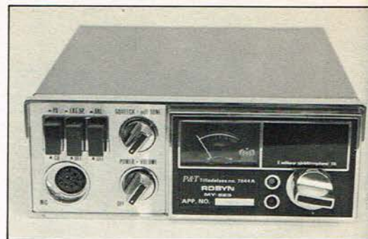
MY 523 Robyn i ensom majestæt. Apparatet passer direkte ind i et basismodul med tilslutning til 220 volt AC.
