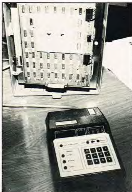
Den regnemaskinelignende programmeringsenhed. I midten til venstre findes et display, hvorpå kodecifrene vises.
