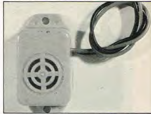
Den lille elektroniske summer, som uden printet afgiver en konstant tone. Tilsluttet printet afgives en pulserende tone.
