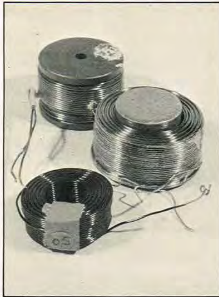
Spoler kan vikles på andet end luft, som den forreste. Den bageste er viklet på ferrit med en selvinduktion på ca. 1,2 mH, mens den midterste er viklet på P-kerne med selvinduktion på 2,5 mH. Bemærk iøvrigt forsidefotoet på PE nr. 4/78 - dér er en P-kerne spole med!
