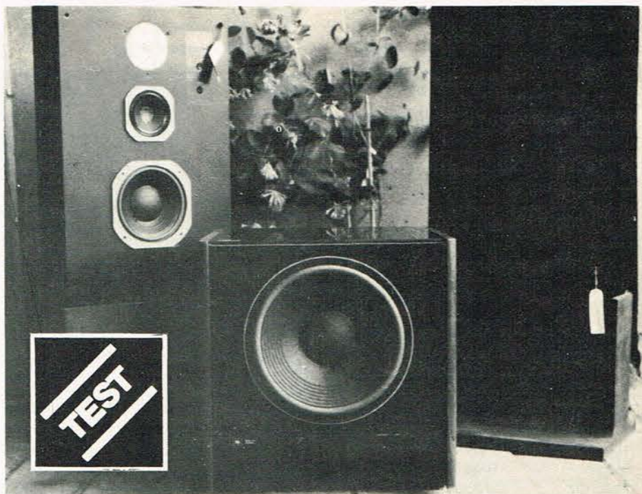
Sidesystemerne består af en 8" basenhed, 5" mellemtoneenhed og en 3/4" domeenhed.
