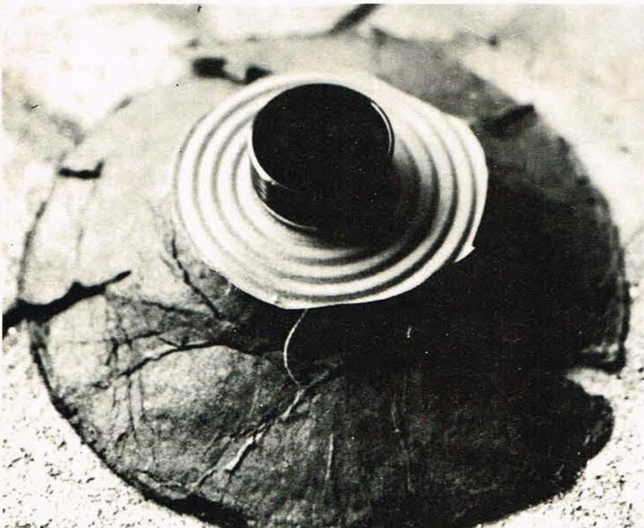
Den kraftige i fire lag viklede svingspole er ansvarlig for det ry vedrørende holdbarhed Cerwin Vega har opnået.
