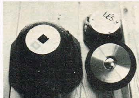
Sidesystemernes enheder. Bemærk den 3,7 kg ALNICO V magnet på basenheden.
