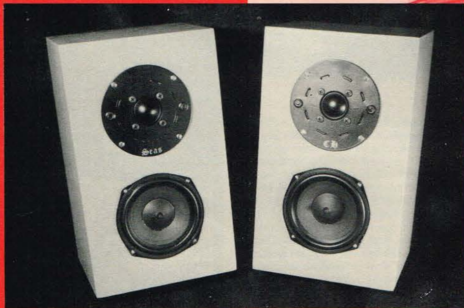
Sidesystemerne baseret på en 4 1/2" basenhed med stor spredning og et bredt frekvensområde.
