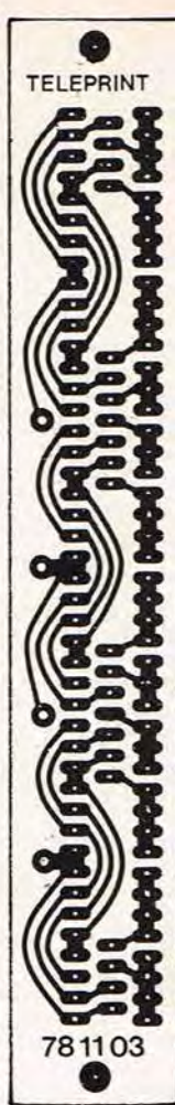
De 44 dioder monteres på det smalle print. Printtegning set fra kobbersiden.
