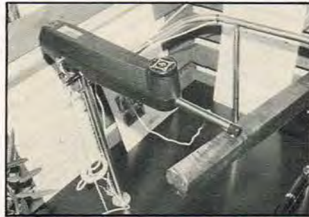
Udstillingens mindste selvstyrer, den driver direkte rotpinden med den indbyggede motor.
