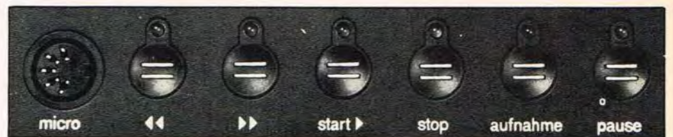
Betjeningspanelet på kassettedelen. Berøringskontakter med LED-indikering.
