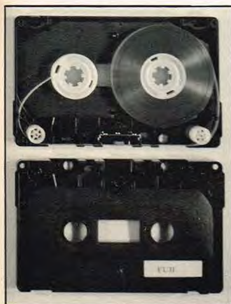
FUJI: Kassetten minder en del om Maxells. Glidefolie med smørelse, og sløjfekarner af stål.
