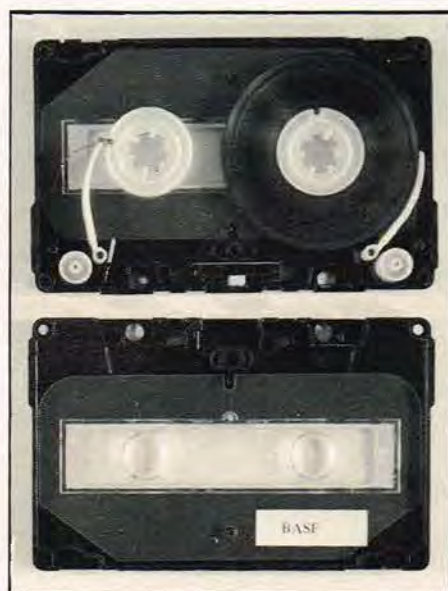
BASF:Kassette af meget høj kvalitet. Der er båndstyringsarme og kærnerne i båndsløjferne er udført af stål. Glidefolien er behandlet med tørsmeringsmiddel. Afskærmningsblikket er ikke ret kraftigt. På de første kassetter af BASF Chrom Super vi så var der også et båndstyr i toppen af kassetten udformet som en vippe. Hvor er dette båndstyr blevet af?
