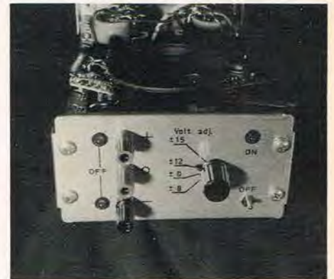
Forpladen indeholder de mest nødvendige reguleringer samt visuel indikering.
