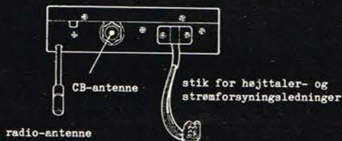
Sådan tilsluttes de to højttalere til 1240.
