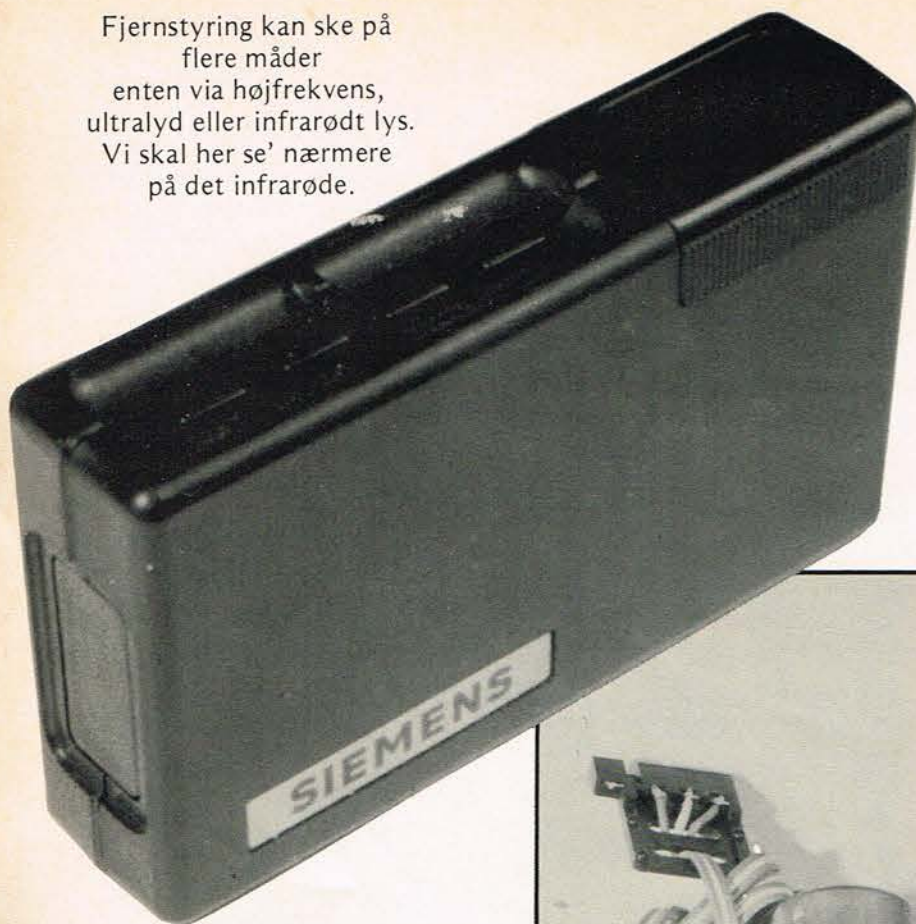
Senderen med vinduet til venstre, tasterne ses foroven og denne er en firekanal udgave. Dækslet helt til højre, skjuler et lille 9 volt batteri.
