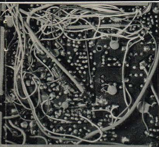
Når en klap i bunden af radioen fjernes er der god adgang til evt. service.
