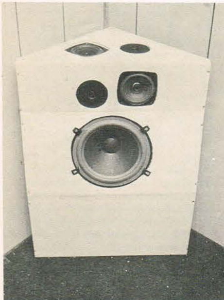
KALOVOK H 3120 120W 3vejs Delefre. 400-3000 Bas 10 T 2 mel. 4,5T 2 dis 3 1/4 T dome Systemresonans 26 Hz.
