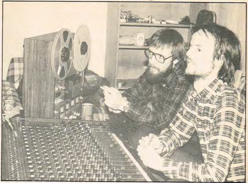
Via Mape-mixeren udtages to basale kanaler som køres ud i firekanals-maskinen. Signalerne indeholder ikke sang eller soloafsnit.
