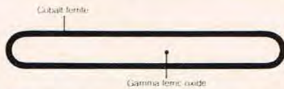
Sådan er det magnetiserbare materiale på et Maxell UDXL opbygget.
