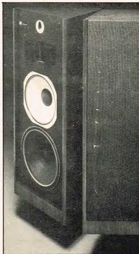
JBL L220 er en stor højttaler, som baserer sig på en modificeret udgave af LE 14, og me elliptisk diskantthorn.
