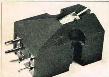
Denon DL 103: Dynamisk pick-up, anbefalet nåletryk 25 - 30 mN, følsomhed 0,06 mVs/cm uden transformator, nåleeftergivelighed 5 mm/N, største kanalafvigelse 1 dB, kanaladskillelse større end 25 dB, elektrisk impedans 40 ohm plus/minus 20%, anbefaler belastnings-
