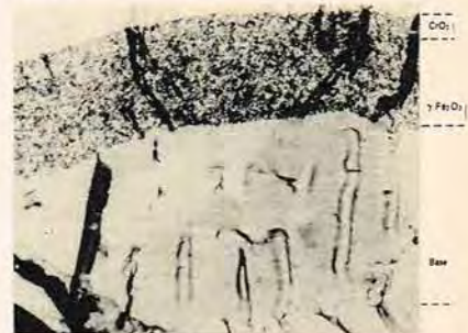
Tværsnit af et dobbeltcoated bånd. Forstørret 4000 gange.
