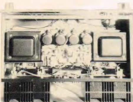
Alpha 3 er udført med dobbelt strømforsyning og MOS-FETS.
