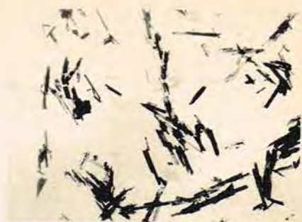
Magnetisk belægning forstørret 35000 gange i et elektronmikroskop.
