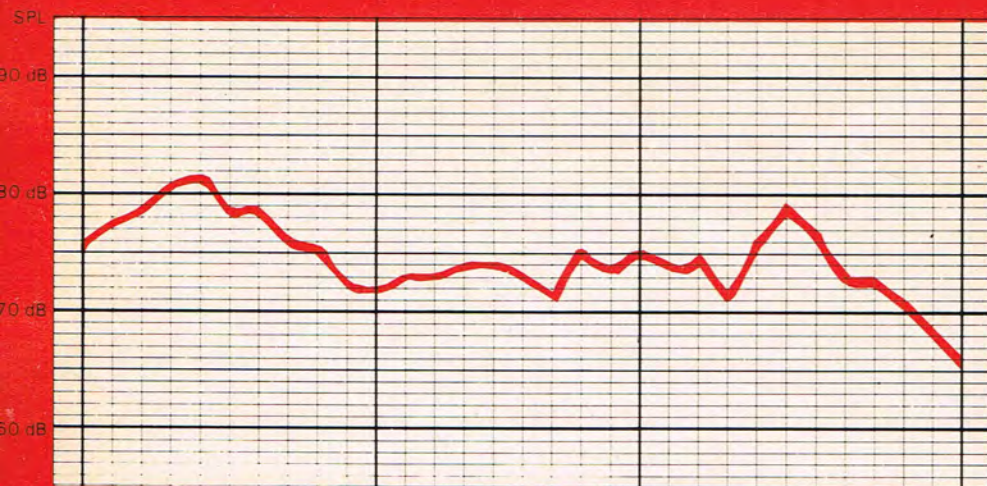
Kurven over 124 TR målt i standardrum.
