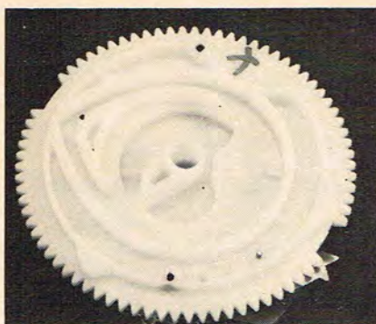
Dette kamhjul udvirker den automatiske indføring af armen på pladesoilleren. Det er vægten af pladen som detecteres, og bestemmer om der spilles 45 ell. 33omdr.
