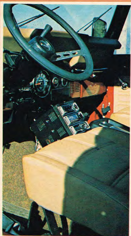
Clarion-systemet lader sig let installere i biler med tilbagetrukket gearskift eller ratbetjent automatgear som her.
