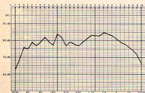
Frekvenskurve over højtalerne CS -602 målt i lytterum med let vinklede højtalere.
