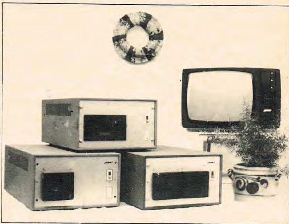
Det modulære princip muliggør mange forskellige datamatyper. Her ses datamaten udstyret med henholdsvis en- og to båndstationer samt floppy disk.
