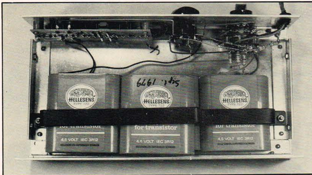
Transistortesteren monteret i kabinet. Låget fjernet.
