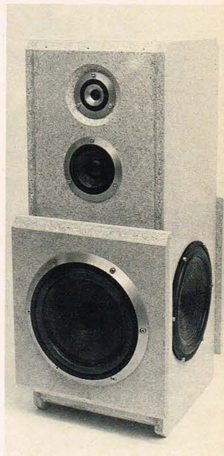
Alle fem højtalerenheder er fastmonteret i kabinettet. Vi har brugt unbrako-bolte og islagsmøtrikker, men træskruer kan gøre det.
