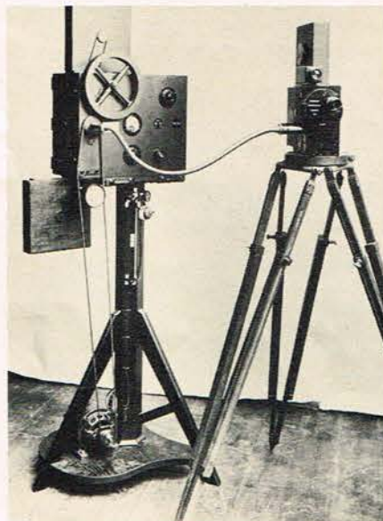
◀ I starten blev tonefilmen optaget med to adskilte apparater - et for lydfilm, og et for billedfilm.
