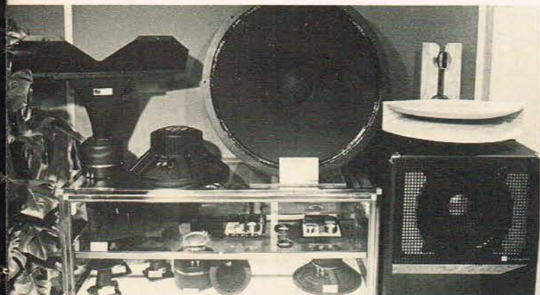
Bemærk den store bashøjttaler. Den er på 30". I kabinettet ved siden af sidder der en 15", der jo normalt regnes for stor.
