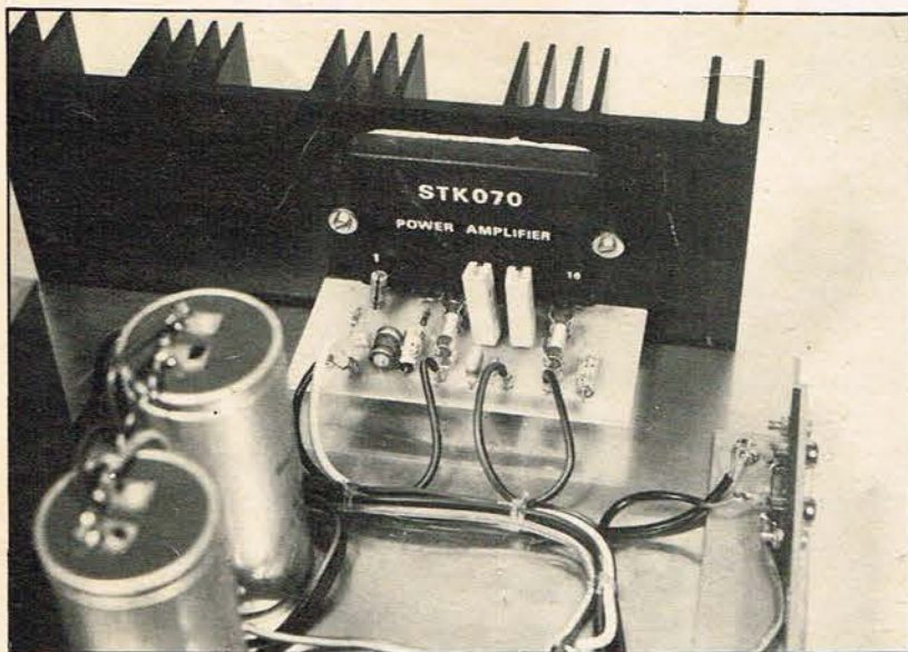
Det er særdeles vigtigt at der er rigelige kølefiner til STK 070
