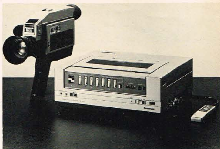
Her er hovedbestanddelene i Panasonic's bærbare videoudstyr: Kameraet WV-3000 og videorecorderen NV-3000.
