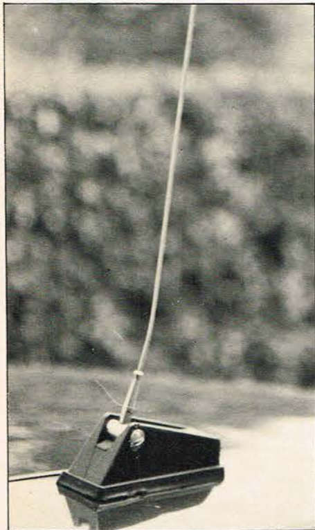
Denne antenne fra FUBA er monteret på bagskærmen, men tabet i det længere antennekabel har ikke den store betydning, da antennen er elektronisk, og giver en forstærkning på ca. 8dB.
