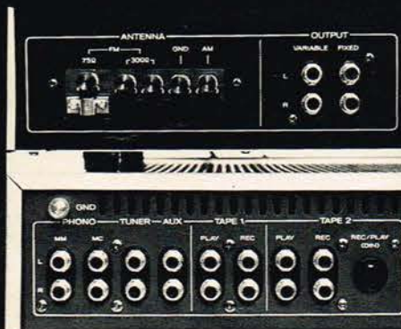
Øverst ses bagsiden af tunerens T-9, nederst af forstærkeren A-7. Som det ses er der nok af tilslutningsmuligheder.
