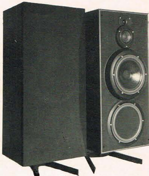
Princippet i den frekvensselektende slave-højtaler betyder, at slaveenheden aldrig arbejder i modfase - systemet er patenteret.
