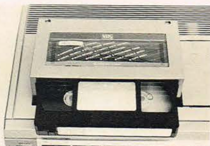
Kassetelugen glider langsomt op når der trykkes på eject. Den er nemlig luftdæmpet.
