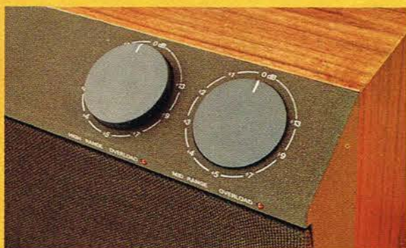
Betjeningspanelet med den nye "push-turn" regulering samt indikatorerne for overload kredsløbet.
