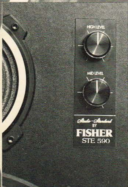
Niveaueet for mellemtone og diskant, kan reguleres separat via et par potentiometre på fronten. Dette giver gode muligheder for tilpasning under forskellige lytteforhold.
