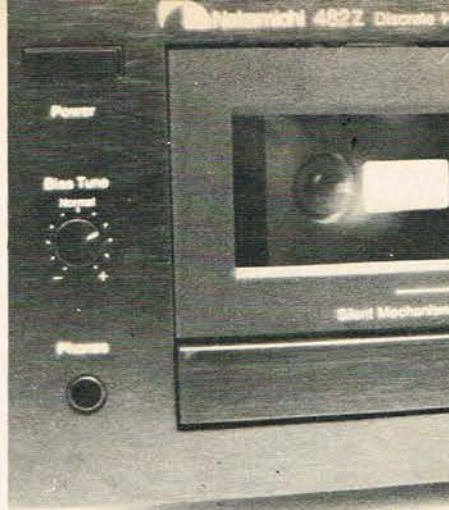
Her ses bias-finjusteringen, som muliggør optimal tilpasning til alle båndvarianter.
