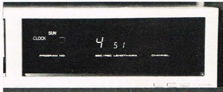
På det store display kan skiftes mellem visning af tid eller båndlængde.
