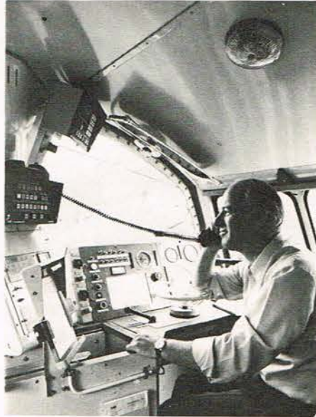
Ca. 400 lokomotiver og styrevogne får monteret strækingsradio. Her ses anlægget i en styrevogn.
