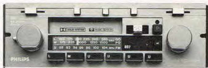
AC 800 GT Stereo De Luxe FM/MB/LB med stereo-kassettafspiller med MSS (Music Sensor System) — musikfindersystem, hvor afspilleren selv finder næste ophold mellem 2 musikstykker under hurtig frem- eller tilbagespoling. Automatisk gentagelse af båndside (autoreplay) efter tilbagespoling. Super fladt Prestolock-forvalg af 6 faste stationer og trinløs variabel tonekontrol og balancekontrol. Udgangseffekt 2 x 6 watt. Pris kr. 2.795,00.
