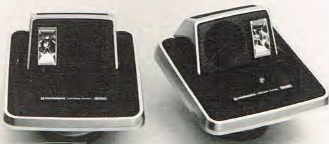
TS 1650 Cross Axial højttaler, 3-vejs system med 1,3 cm diskant, 5,7 cm mellemtone og 16 cm basenhed. Max. input: 60 watt. Frekvensområde: 35 - 21000 Hz. Pris ca. 845 pr. stk.
